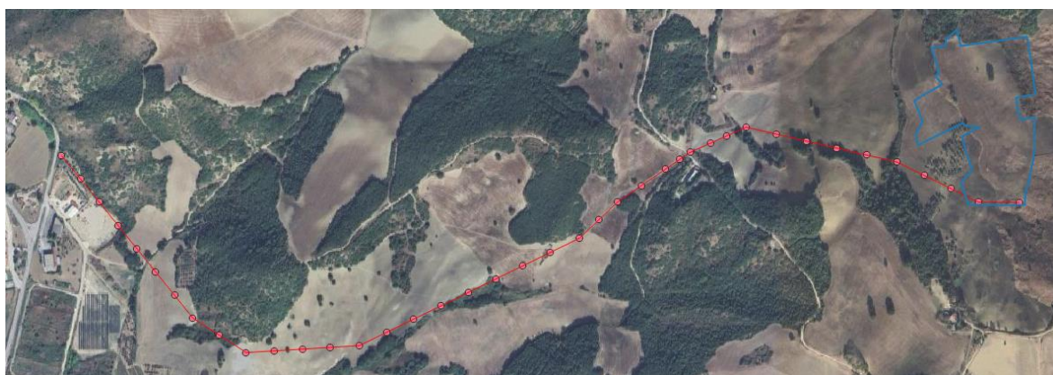
Figura 2. Tracciato cavidotto Media Tensione
